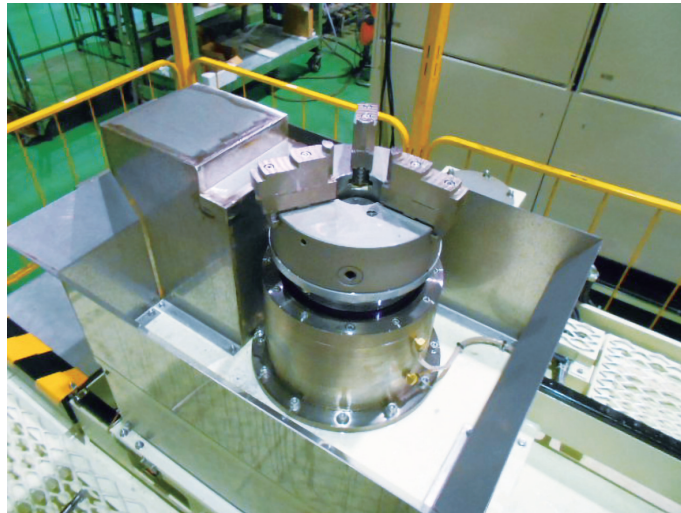
船舶用ギヤ焼入装置のワーク回転ユニット (ギヤ焼入用回転機構およびシャフト焼入用回転機構)
