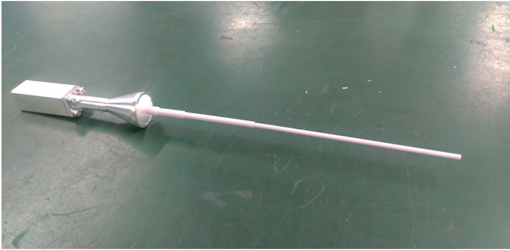
28GHz 帯階段形誘電体ロッドアンテナ(試作機) 矩形-円形導波変換器、励振ホーン、階段形誘電体ロッドで構成。 従来のテーパ形アンテナの簡易形でありながら高利得性能を実現。
